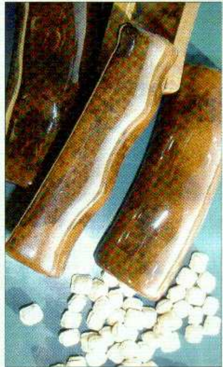
Formsache: Das verflüssigte, größtenteils auf zerkleinerten Naturfasern basierende Granulat lässt sich in beliebige Formen gießen.
